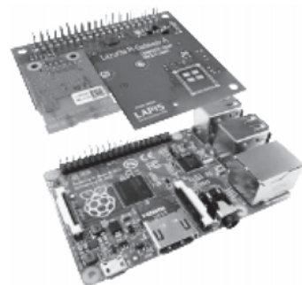
Raspberry Pi/Lazurite Pi Gateway ゲートウェイを実現 Linux コンピュータ(下) と無線モジュール(上)
